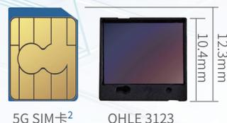
OHLE 3123是一款基于氧化钒 (VOx) 微测辐射热计技术的SWLP长波红外探测器。面阵384×288, 像元间距12μm, NETD<40mK, 功耗<65mW, 响应波段在8-14μm。全新的窗口设计, 打破环境限制, 无需洁净车间, 常规环境即可组装。匹配SMT<sup>1</sup> 贴装技术, 可快速实现批量。具有超小体积、超轻重量、高品质成像、集成方便等特点。OHLE 3123适合多种应用场景, 如户外夜视、工业测温、安防监控、民用行业无人机等领域。
